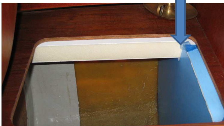
Herover ses tilpasning af første sidestykke. Falsene giver plads til listerne i apteringen.
